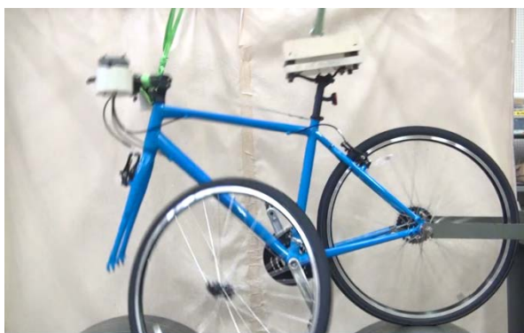
写真8. 前車輪が脱落した様子
