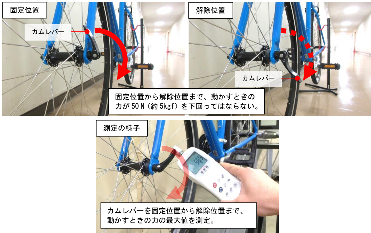
写真6. カムレバーの締付け解除操作力
